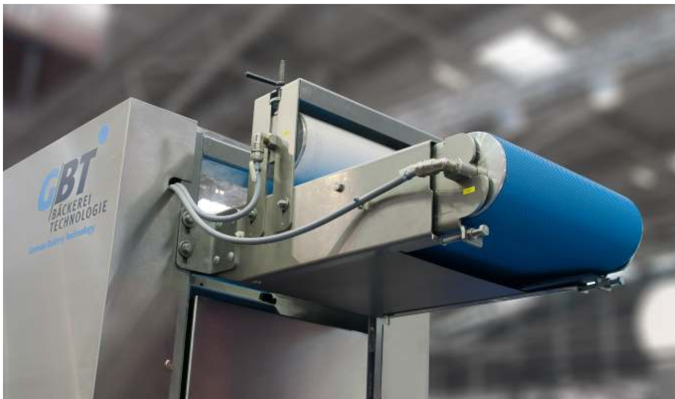
Trommelmotor zowel als aandrijving van de transportband als een -in hoogte verstelbare- boven de band geplaatste aandrukrol.
