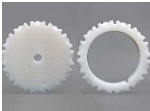
Kettingwiel kunststof - origineel en uitgedraaid
