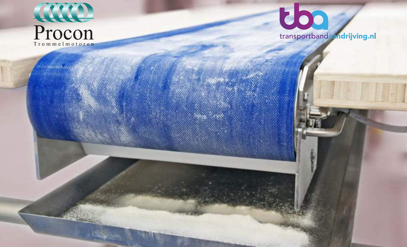
PT 113 X als aandrijving van een transportband in een werktafel.
