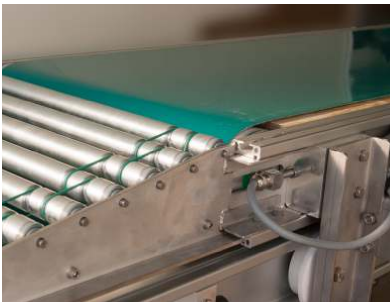
PT 113 X2 met speciaal deksel met daarin een 5 mm brede groef voor een rondsnaar (zie foto rechts), die een korte rollenbaan mee aandrijft
