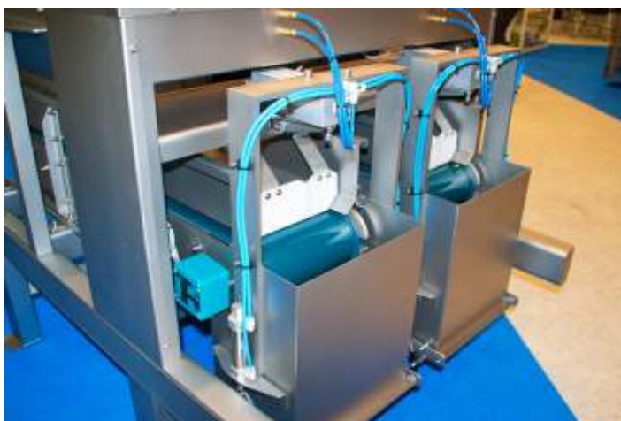
Plaatsbesparend inge- bouwd in twee weeg- units, duwend opgesteld.
