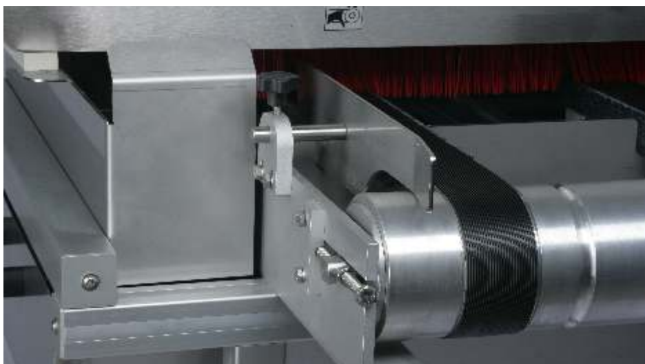
De mantel is zodanig bewerkt, dat er zowel rondsnaven als riemen mee kunnen worden aangedreven.
