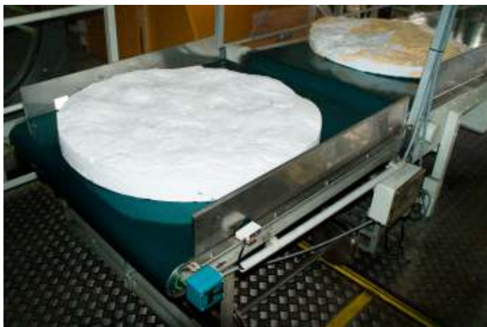
In een wasserij. Trommelmotor voor band- breedte 1.100 mm.
