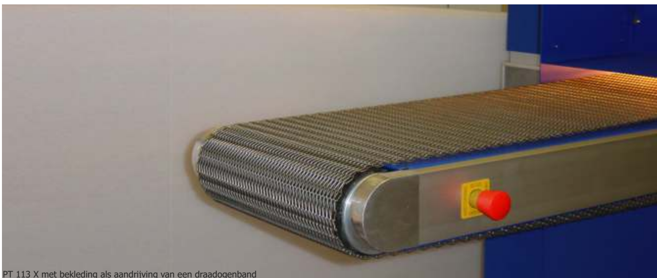
PT 113 X met bekleding als aandrijving van een draadogenband
