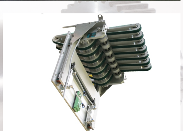
Gelijktijdig aandrijven van 7 tandriemen met 1 trommelmotor
