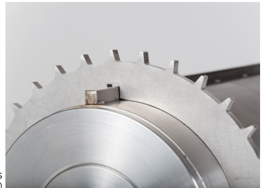
Kettingwiel RVS (lasergesneden)
