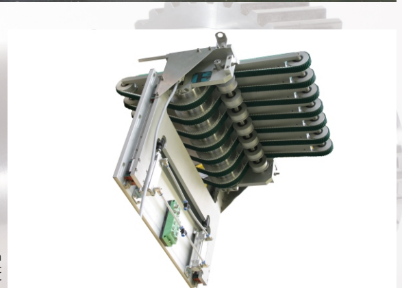
Gelijktijdig aandrijven van 7 tandriemen met 1 trommelmotor
