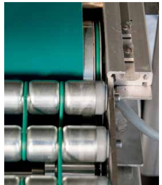
PT 113 X2 met speciaal deksel met daarin een 5 mm brede groef voor een rondsnaar (zie foto rechts), die een korte rollenbaan mee aandrijft
