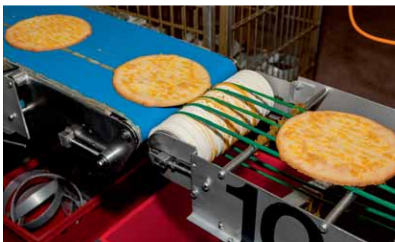
Als aandrijving van een rond- snaren transporteur in de voe- dingsindustrie.
