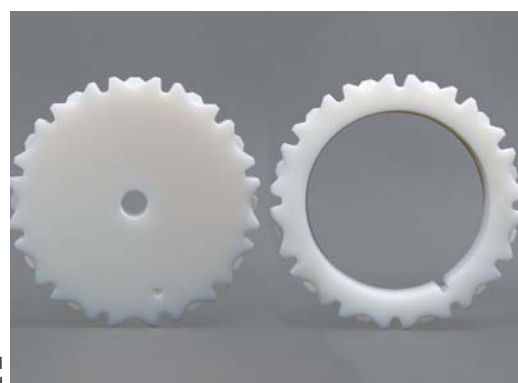
Kettingwiel kunststof - origineel en uitgedraaid
