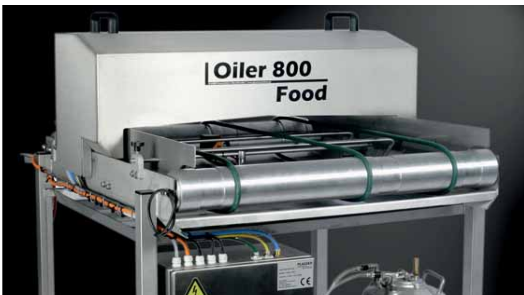
Zodoende kan met één trommelmotor twee soorten machines worden aangedreven. Reductie van (speciale) componenten zorgt hier voor besparing op de voorraadkosten.
