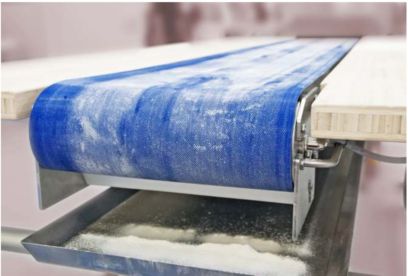
Procon trommelmotor als aandrijving voor een transportband in een werktafel in de bakkerij industrie.
